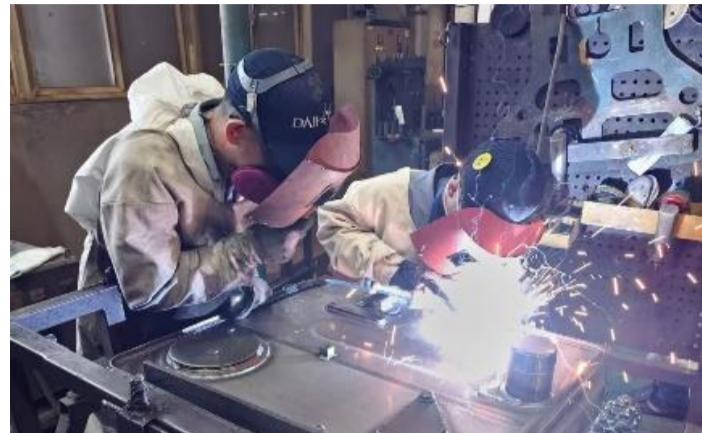
DMS現場実習の様子(TANK溶接)
